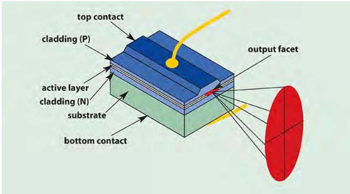
**Figure 1-3. - Laser Diode**
