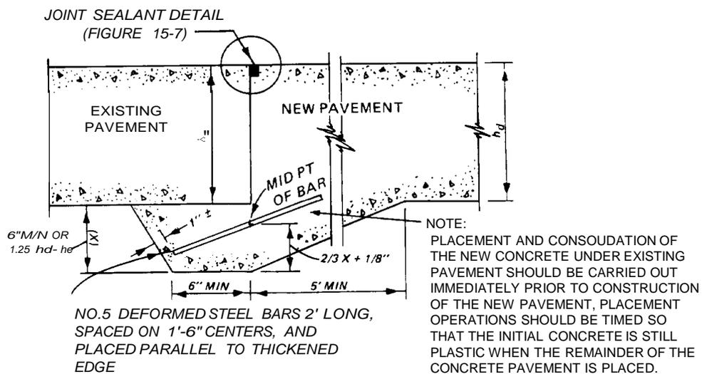
f. SPECIAL JOINT BETWEEN NEW AND EXISTING PAVEMENT
